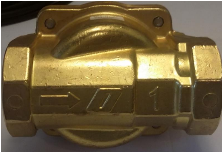
Abbildung 1: Ansicht von unten. Der Pfeil zeigt die Durchflussrichtung an.
